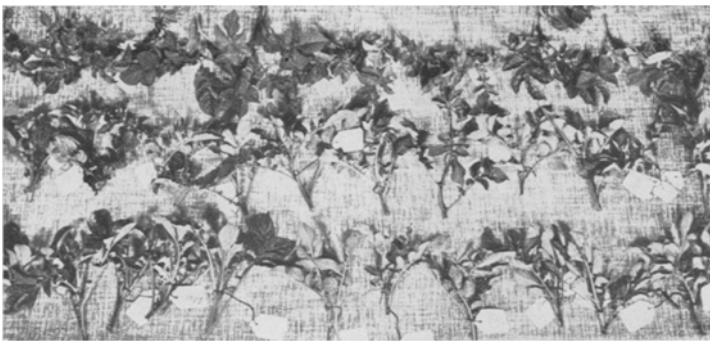
Abb. 2. Anordnung der Kartoffel-Triebspitzen für die Frostprüfung.
